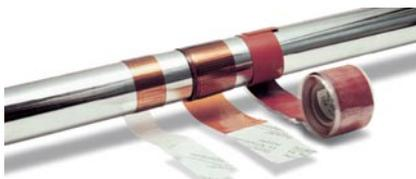
客户定制的收缩带是可以预拉伸的薄膜带，两端涂有粘合剂。缠绕电热片并加热使之收缩。伸展带无需加热即可快速安装。
