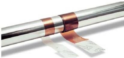
**PTFE（聚四氟乙烯）**：一种柔性的电气绝缘材料，以其“不粘”特性而出名。它通常因其出色的耐化学腐蚀性而得到青睐。
